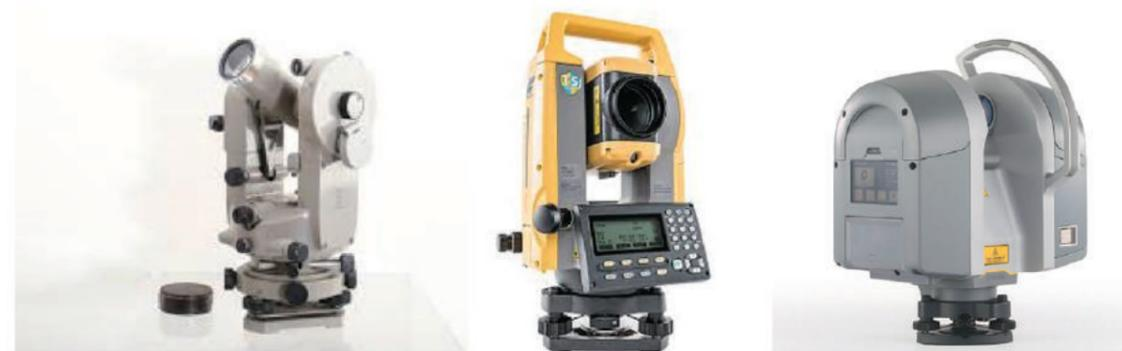
写真 トランシット（左）、トータルステーション（中）、地上レーザスキャナ（右）
