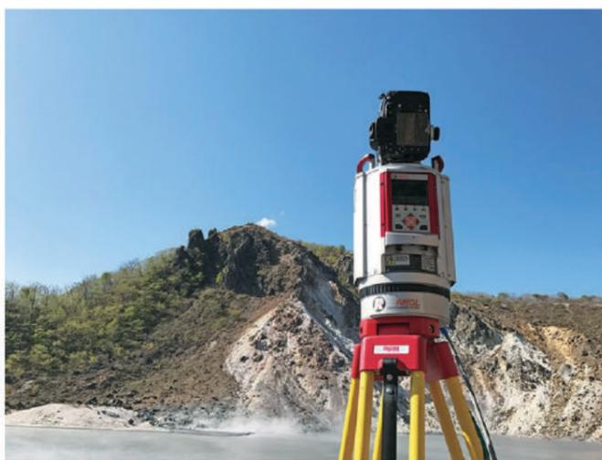
写真 地上レーザスキャナによる計測風景
